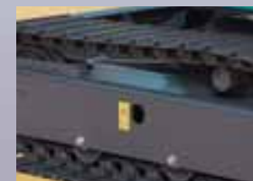
泥落ちのよい片流れローラフレーム。
