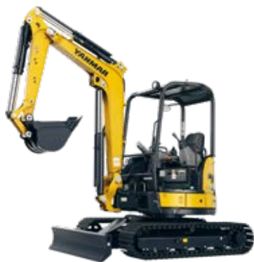
4柱キャノピー仕様(ROPS※1/FOPS※2基準)
