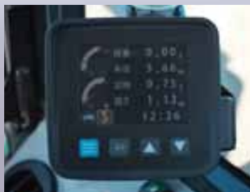
ハイリーチクレーン仕様の定格荷重表示例
