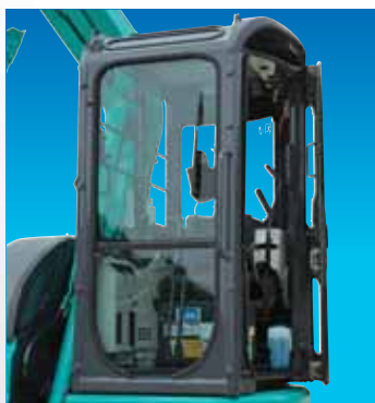
乗降時に大きなドア開閉スペースを必要としないスライドドアをクラス初採用。壁際ぎりぎりでも開閉できます。
