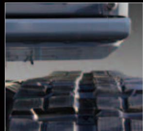
拡幅したアッパーとシューの間隔
