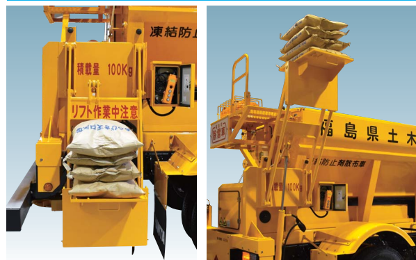
散布剤積込装置(国土交通省タイプ)
