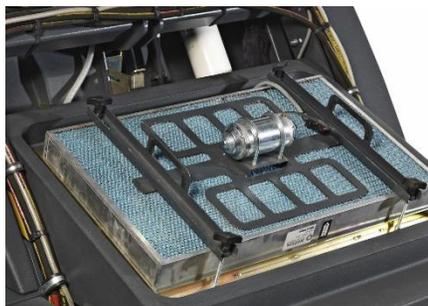
メンテナンス性に配慮されたアクセス性の高い大容量10m<sup>2</sup>パネルフィルター。周波数変動式フィルターシェイカーが効率的に粉塵を落とし、高いフィルター性能を持続させます。
