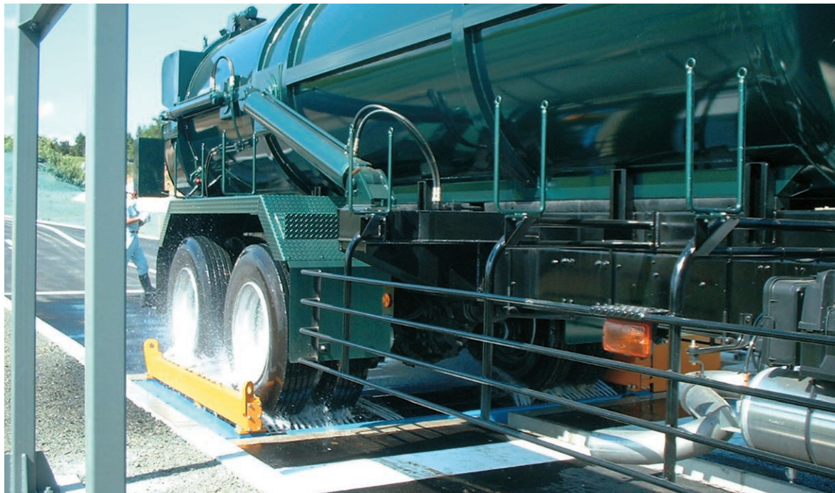
洗浄の噴射状況
