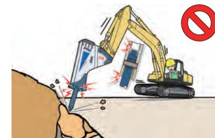
斜め打ちは、ロッドのすべりによるロッドのかじりやロッドを折損させる原因になります。
