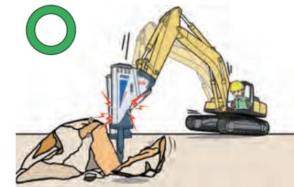
破砕したらすぐに打撃をストップします。空打ちが多すぎると、ブレーカの各部を傷めます。
