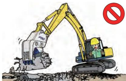
作業装置が履帯に対し直角方向になる状態で作業を行うと、油圧ショベルの浮き上がりや横転などの恐れがあります。
