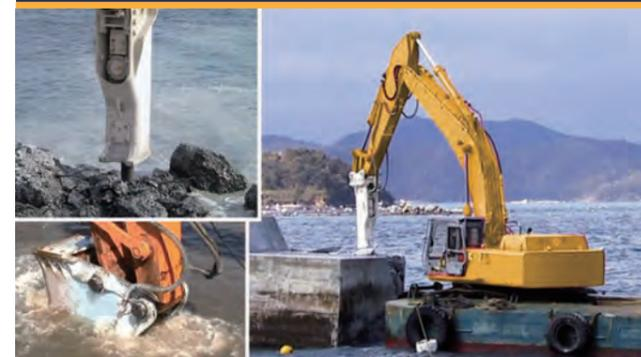
エアコンプレッサを搭載することで油圧ブレーカ本体内部への水の浸入を防ぎ、水中での作業を可能にしています。ロッド部が水没する水中での破砕作業に使用されます。
