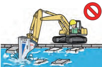
ブレーカ本体に水や泥が入り、ブレーカだけでなく油圧ショベルの重大な故障にもつながります。
