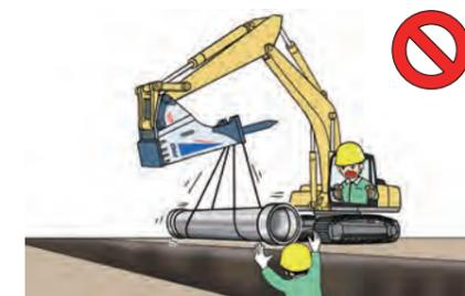
ブレーカでのクレーン作業は禁止されています。クレーン作業（荷の吊上げ）を行うときは、専用の機械を使用してください。
