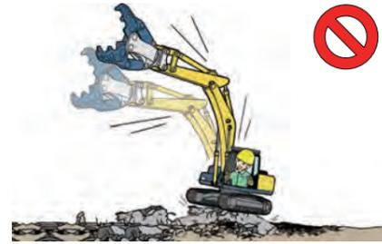
平坦で堅固な地盤の上で作業を行ってください。建物内では、地盤割れや倒壊の恐れのある危険区域に立入らないでください。
