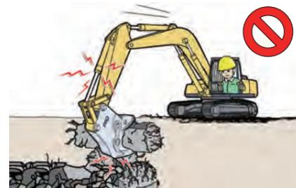
油圧ショベルのシリンダに無理な力が加わり、ロッドの曲がりや抜け、リンクの折損などを引き起こす原因になります。
