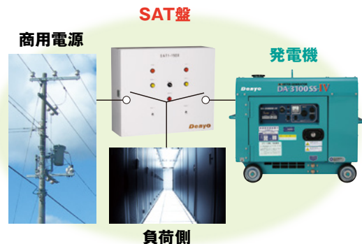
簡易自動始動盤 (SAT盤)※2
