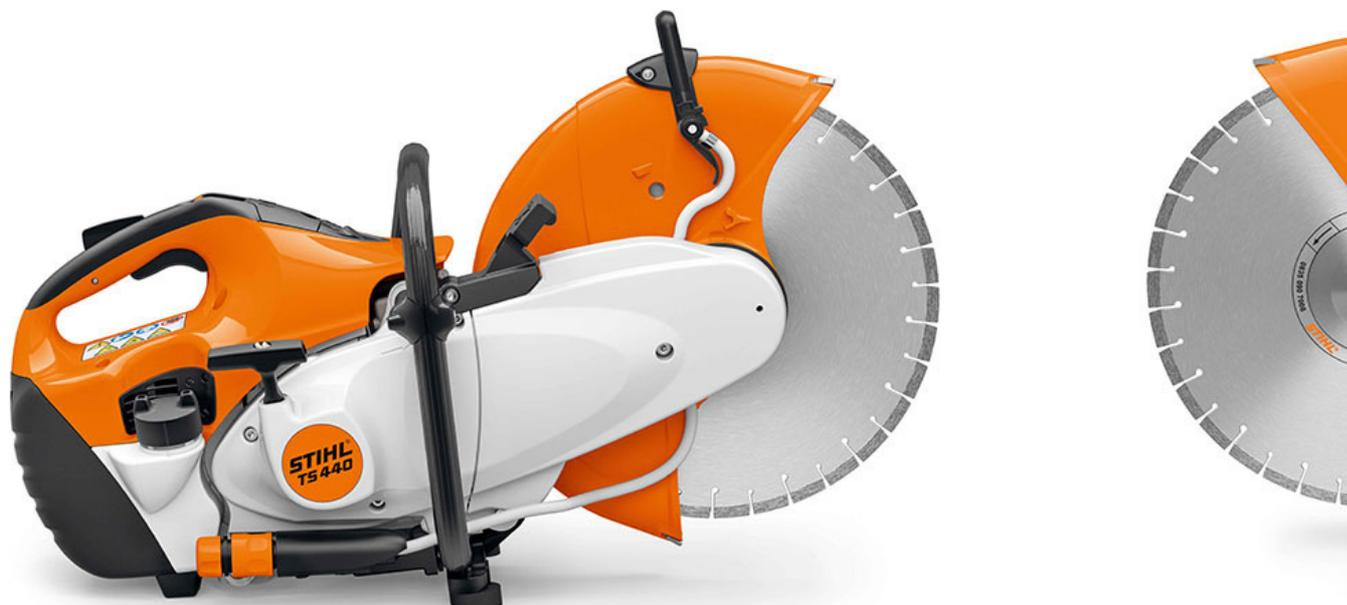
切断作業中にキックバックが発生したとき、瞬時にブレードの回転を止めるSTIHL クイックストップブレードブレーキを搭載した世界初のカットオフソーです。作業者にとっては、ブレード上部を使用する作業も行いやすくコンクリート管や鉄管などの切断作業が非常に楽になります。土木建設業、上下水道工事業などでの使用に最適なモデルです。\* 2019年5月9日現在。STIHL グループ調べ
