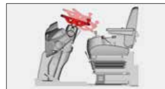
チルト&テレスコピック機能付きステアリングホイール ポップアップステアリングコラムとペダル
