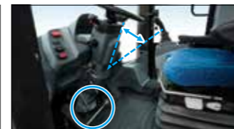
チルト&テレスコピック機能付きステアリングホイール ポップアップステアリングコラムとペダル
