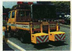
バック・ガード(仮設式) (車両追突衝撃吸収装置)
