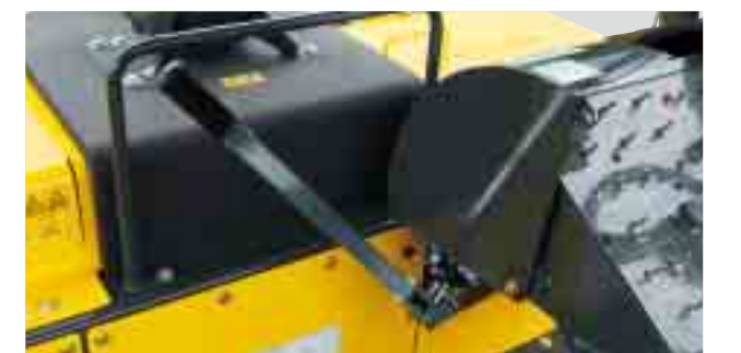
シリンダ手動操作が可能なハンドポンプ(オプション)
