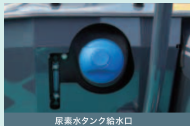
尿素水タンク給水口
