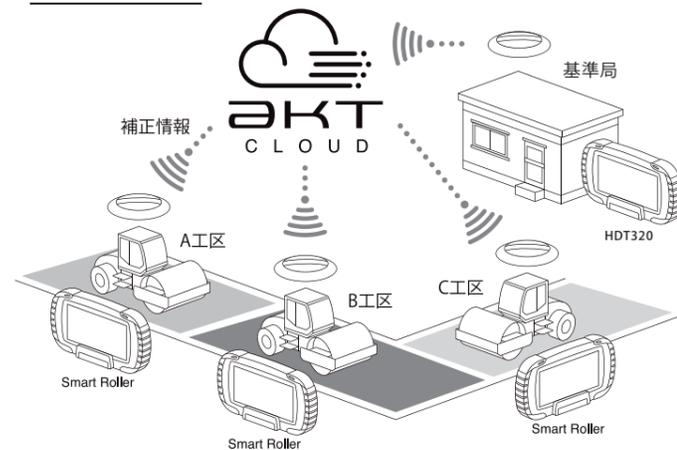
※基準局1台から複数の工機に補正情報をWEB配信(約10km以内)
