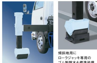
傾斜地にローラジャッキ専用のゴム製盤木も標準装備。
