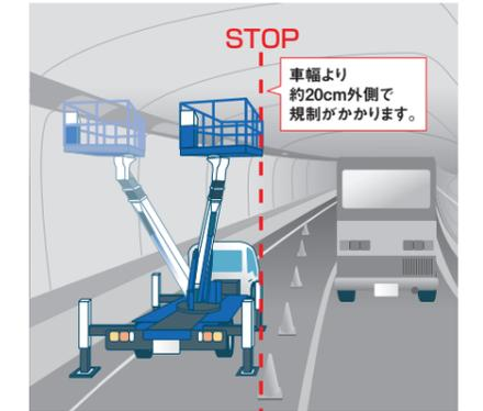
作業中にデッキが対向車線側に飛出さないように自動制御を行います。現場の状況に応じて、車体の右側・左側どちらでも飛出防止設定が可能。細心の注意を必要とする車線などにおいて、デッキ操作をサポートします。
