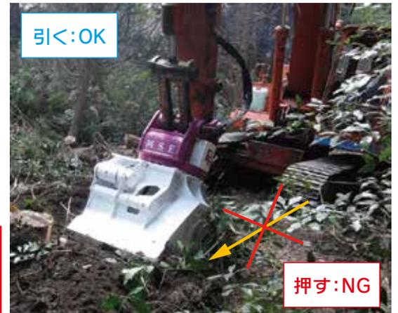
バケットを傾けた状態で岩等を叩くと、爪1本に過大な力がかかって爪が破損する恐れがあります。また切株を爪で叩き割る動作は、爪が折れたり、ローターの旋回輪が破損する恐れがあります。
