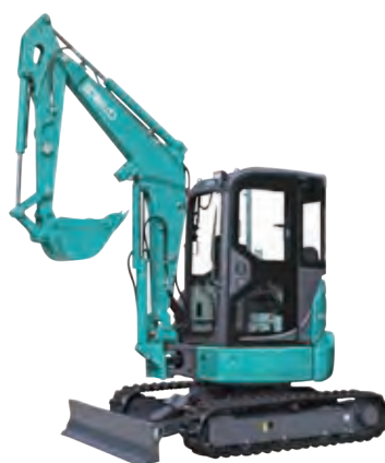
■ミニバックホー 0.08CNB 排土板 KOBELCO SK28SR-6
