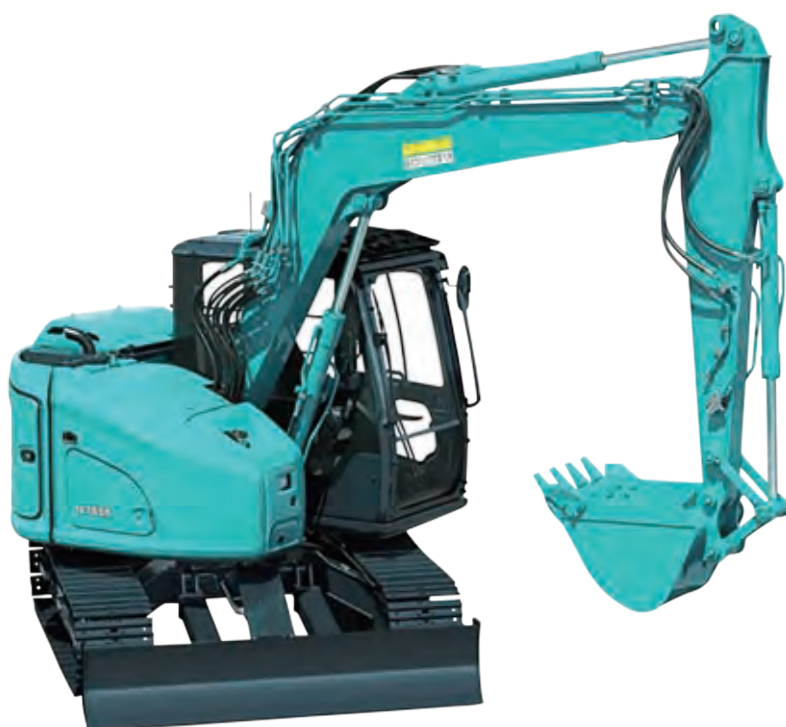
■油圧ショベル 0.25CR & NB KOBELCO SK75SR-7
