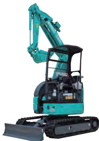
■ミニバックホー 0.1 クレーン付 KOBELCO SK30UR-6
