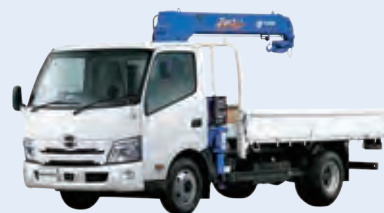
クレーン付きトラック
