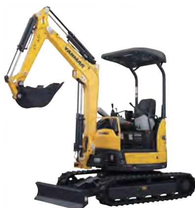
■ミニバックホー 0.066 後方超小旋回 YANMAR Vio20-6
