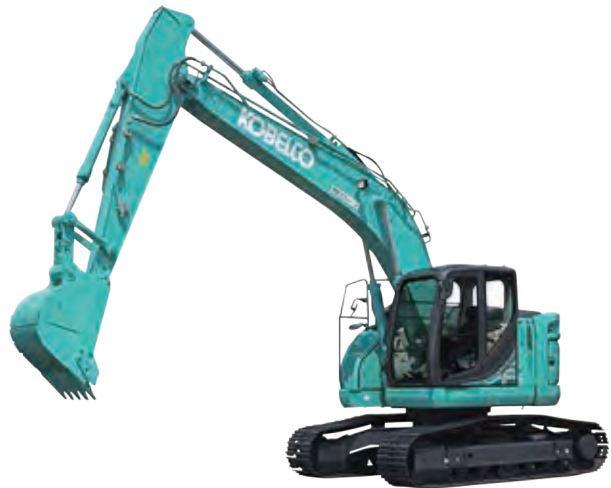
■油圧ショベル 0.7 後方小旋回 CNB KOBELCO SK225SR-5
