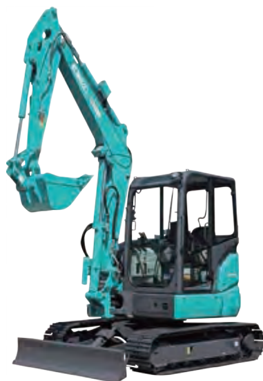
■ミニバックホー 0.2 CR NB 排土板 KOBELCO SK45SR-6E
