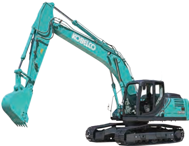
■油圧ショベル 0.7 クレーン NB KOBELCO SK200-10
