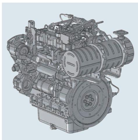
最適な燃料噴射をかなえるコモンレール式燃料噴射システムをはじめ、クールドEGR、ターボなどの採用により、低燃費・低排出ガス・低騒音といった環境性能を追求。同時に従来機に比べ8%のパワーアップを実現、すぐれたレスポンスもかなえています。
